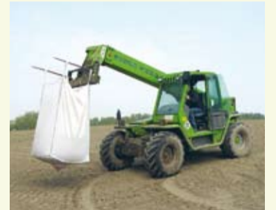
Beim Transport der BigBags leisten Teleskop- oder auch Fronlader gute Arbeit
